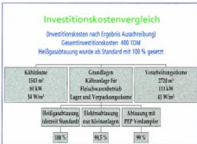
Bild 5 Investitionskostenvergleich (Ergebnis einer realen Ausschreibung) bei Einsatz von Heißgas- und/oder Elektroabtauung sowie Abtauung nach dem PEP-Prinzip
