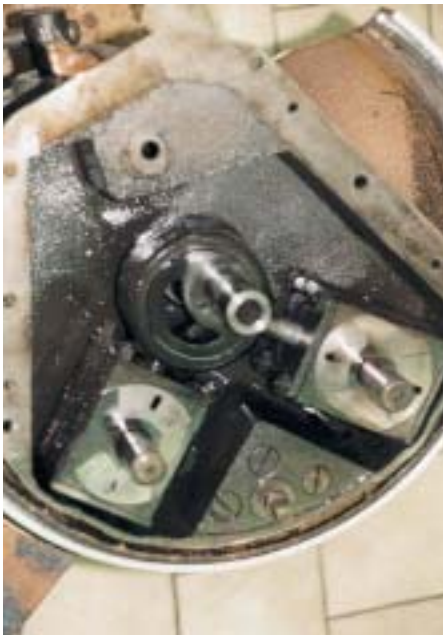
Bild 2 A-S-Maschine an der Sächsischen Kältefachschule im demontierten Zustand. Blick auf die Welle mit dem Exzenter und die beiden Zylinder mit Drehzapfen
