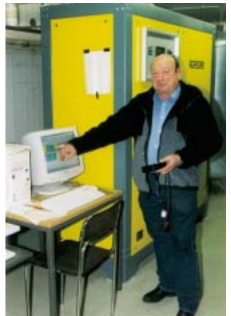
Alle Funktionen und Meßwerte werden elektronisch erfaßt und am Bildschirm auf Abruf visualisiert. Hierzu gibt Versuchstechniker Paul Rief einige Erläuterungen. Dahinter die Adsorber-Zentrale mit Aktivkohle für die kontrollierte CO 2 -Atmosphäre
