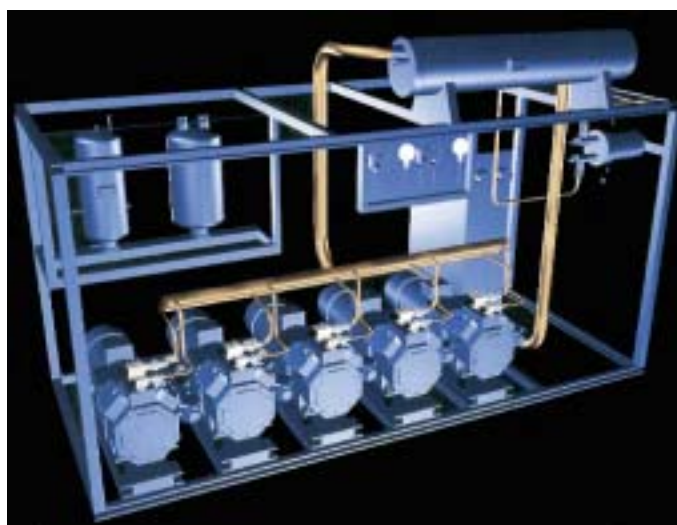
CAD-Zeichnung des Maschinenaufbaus mit 5 HKT-Goeldner-Verdichtern
