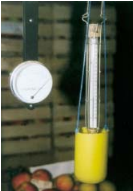
Raum nicht begehbar, deshalb durch die Sichtluke fotografiert, hier der Beweis: Feuchtkugeltemperatur + 2 °C, rel. Feuchte 100 %
