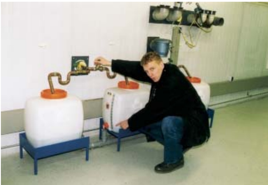
Das zielgerichtete Entfeuchten wird durch die Abtauwasser-Meßmethode kontrolliert. Je nach Lagersorte fallen im Monat zwischen 27 und 54 Liter Abtauwasser in einem 50-t-Lager an
