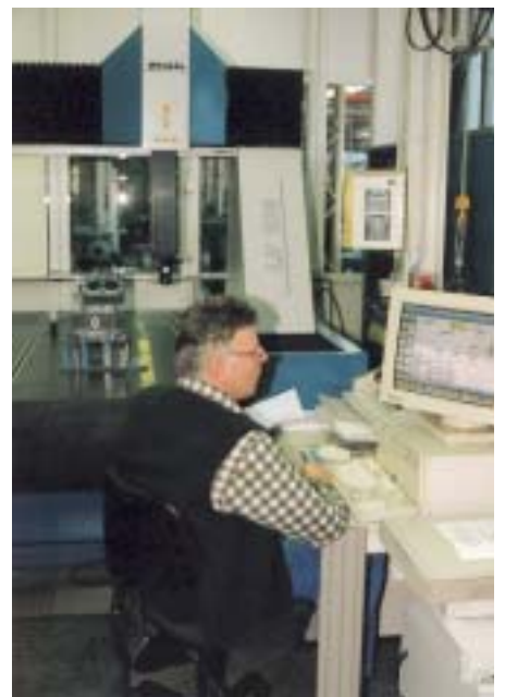
Computergesteuerte 3-D-CNC-Koordinaten-Meßmaschine. Eine festgelegte Anzahl von Gehäusen wird je Schicht auf alle Maße geprüft
