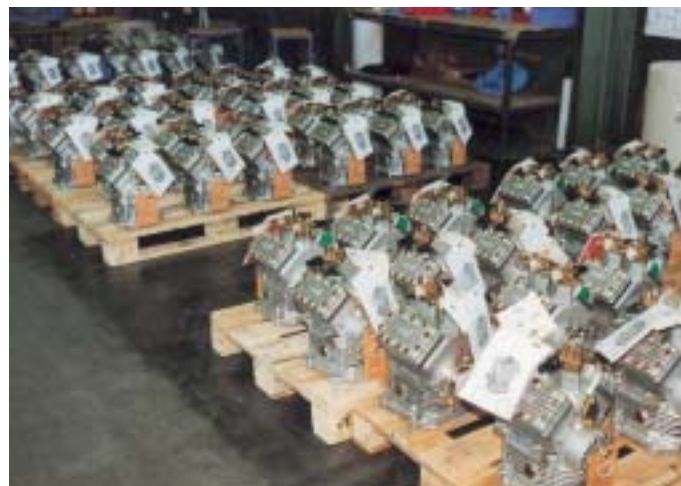
Versandfertige Bock-FK-Verdichter für den weltweiten Einsatz in Bus-Klimaanlagen und Tiefkühlfahrzeugen
