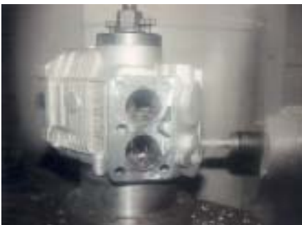
Ein Einblick in ein CNC-gesteuertes Bearbeitungszentrum. Hier wird ein 4-Zylinder-Aluminiumgehäuse bearbeitet
