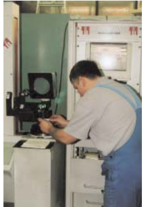
„Optisch-elektronisches“ Vermessen der Werkzeuge für die Werkzeugmaschinen zur Nullpunktbestimmung
