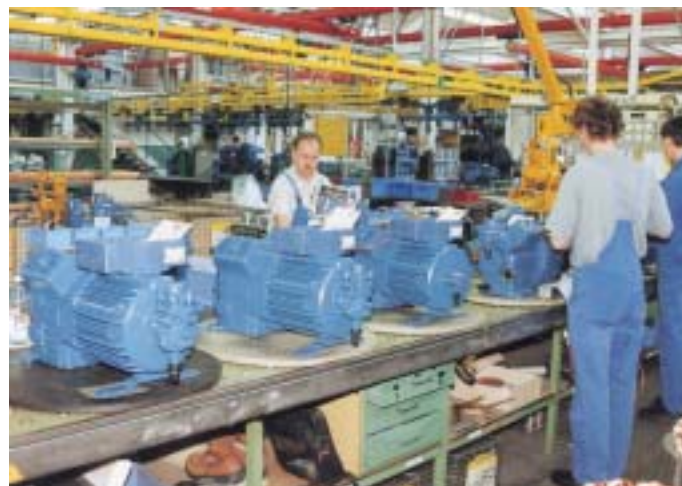
Elektrische Endkontrolle der Halbhermetik-Verdichter
