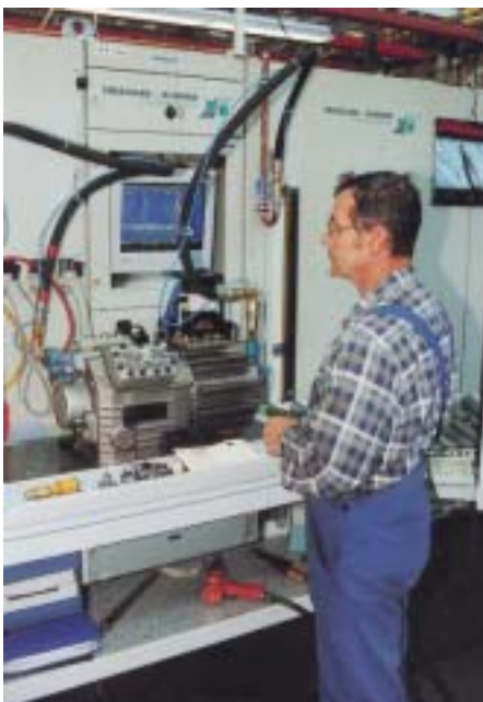
Jeder Halbhermetik-Verdichter wird vor Auslieferung auf „Herz und Nieren“ geprüft. Nur wenn objektiv der Computer O. K. anzeigt, darf der Verdichter zum Versand
