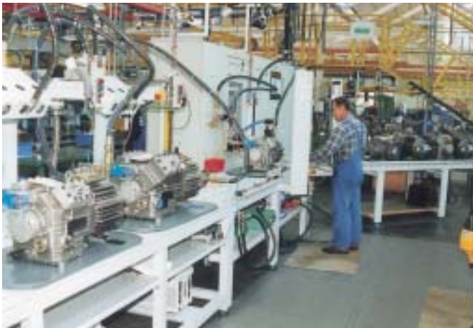
Trocknen, Befüllen und Testen der Halbhermetik-Verdichter
