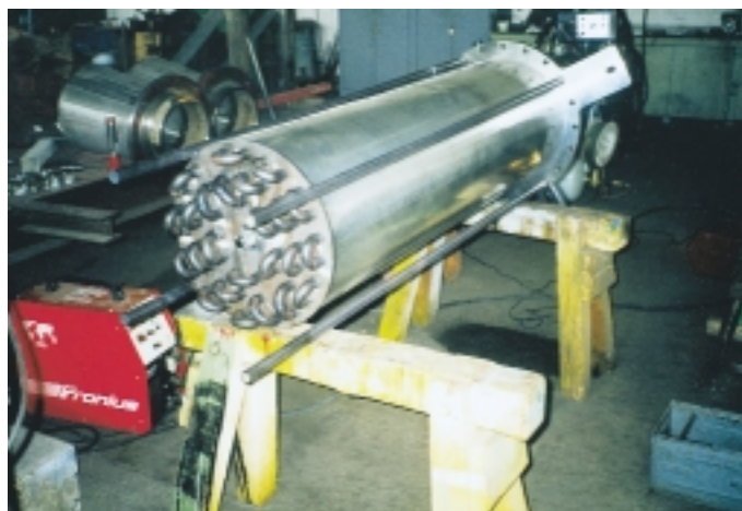
Bild 1 Ringkanal-Wärmeübertrager mit U-Rohren während der Fertigung
