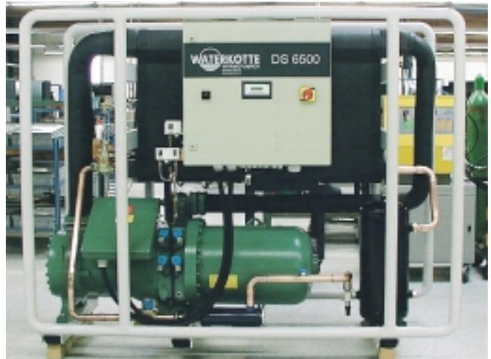
Waterkotte-Wärmepumpe mit Bitzer-Verdichter
