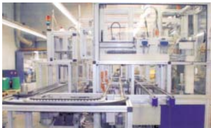
Multiplexline für vollautomatisches Montieren, Schweißen, Kalibri-eren und Helium-prüfen; im eigenen Sonderbau hergestellt
