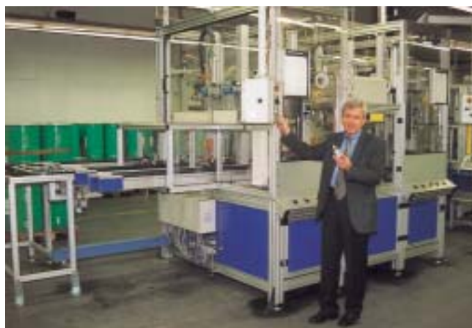
Peter Meyer, Leiter der Proficenter stationäre und automotiv Kälte-Klimatechnik am Helium Prüfstand: „Alle Sammler und Filtertrockner werden vor der Auslieferung bis ins kleinste Detail getestet“
