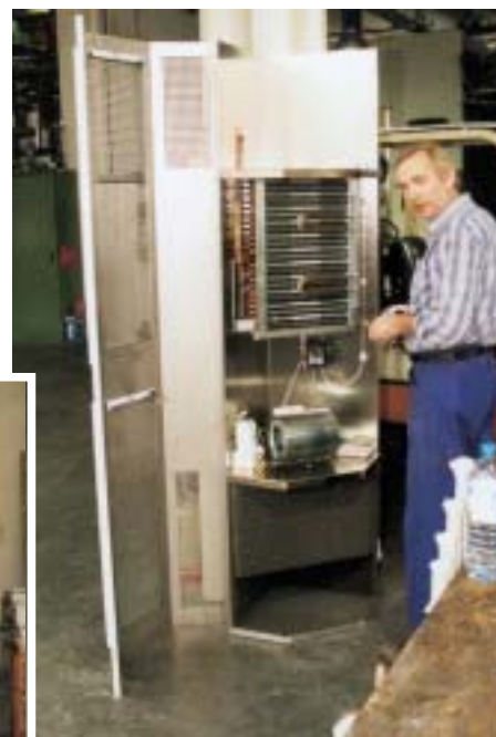
... oder Klimageräte für spezielle Anwendungen, hier für die Eckaufstellung bei der Firma Bosch gedacht, das Leistungsspektrum von opk ist breit gefächert
