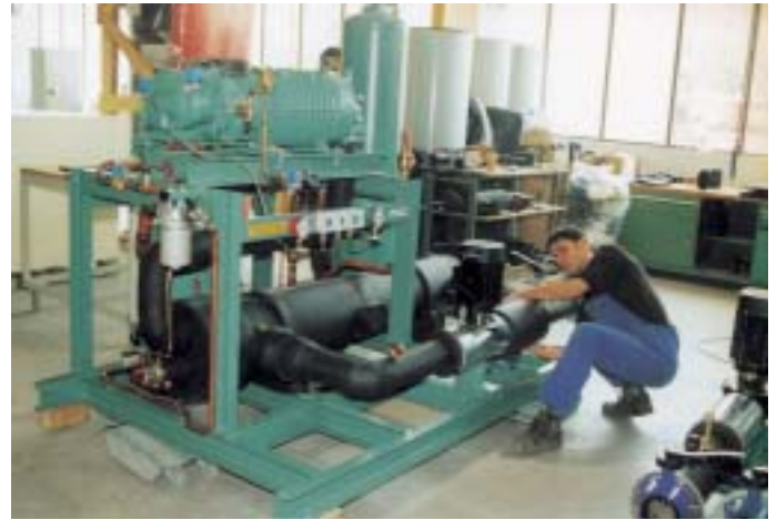
. . . hat Robert Lauth erst dieses Jahr seine Lehre als Kälteanlagenbauer beendet und konnte im Leistungsvergleich für die neuen Bundesländer den 2. Platz belegen. Hier bei der Montage eines Kaltsollesatzes für einen großen Galvanisierbetrieb
