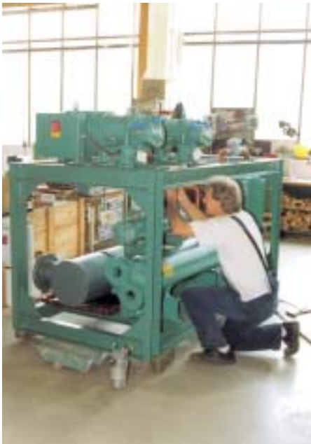
Montage eines Schrauben-Kaltsolesatzes 130 kW (Soletemperatur -10/-14 °C), wassergekühlt, mit zwei Bitzer Schrauben Typ HSK 6461-60Y und einem Alfa Laval Rohrbündelverdampfer Typ EHD 475
