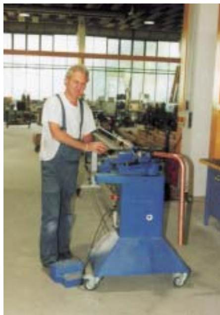
Kupferrohre werden bis zu einem Durchmesser von 54 mm weitgehendst aus einem Stück gefertigt
