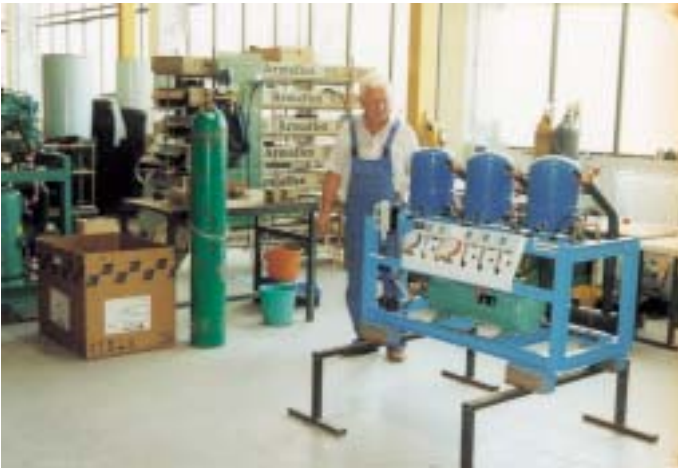
Hermetikverbund in der Standardausstattung Normalkühlung 10,4 kW (-10/45 °C) mit Maneurop Verdichter MTZ 28. Erfahrung und Jugend ergänzen sich gut. Während einige Monteure schon jahrelange Praxiserfahrung auch auf Baustellen besitzen . . .
