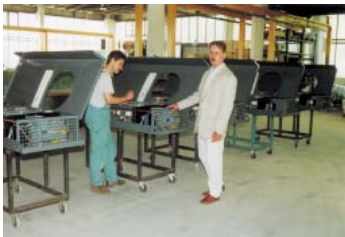
Geschäftsführer Lutz Hering erläutert hier eine Baureihe von Dachkältesätzen, die als OEM-Fertigung für die Kühlung von Führerständen in Schienenfahrzeugen vorgesehen sind
