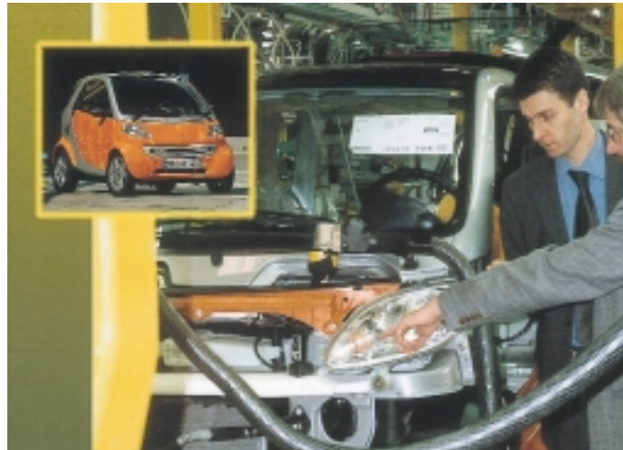
Kältemittel-Befüllstation der Smart-Produktion im elsässischen Hambach
