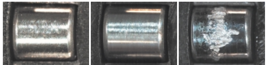
Bild 10 Axialscheiben und Zylinderrollen von Wälzlagern nach wenigen Stunden mit CO 2 (links: neues Lager, Mitte: Versuchöl E 5, rechts: mit herkömmlichem POE-Kältemaschinenöl)
