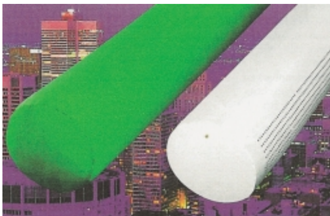
Bild 1 Textile Luftverteiler im Betriebszustand Grün: Ausführung in Trevira CS, luftdurchlässig für Kühlung und Klimatisierung Weiß: Material Polyamid, individuell perforiert zur Warmluft-, in Sonderfällen aber auch zur Kaltluftverteilung
