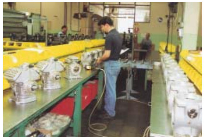
Offene Hubkolbenverdichter in Grauguß und Verdichter für die Busklimatisierung werden am alten Firmenstammsitz Campo Fiori in Florenz hergestellt
