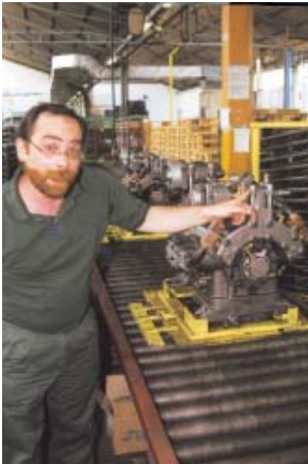
Ing. Flavio Valerio erklärt es: „Bei den kleineren K-Multiconus-Verdichtern ist das Hochdruckabsperrentil auf dem Zylinderkopf montiert, bei den größeren jedoch auf der äußeren Druckleitungsführung“
