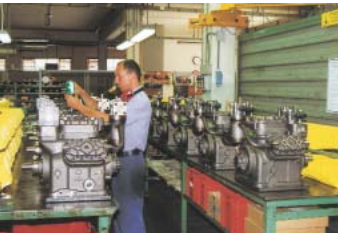
Offene Hubkolbenverdichter in Grauguß und Verdichter für die Busklimatisierung werden am alten Firmenstammsitz Campo Fiori in Florenz hergestellt
