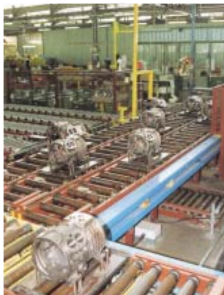
Helium-Prüfstand mit Freigabe eines 8-Zylinder-K-Multiconus-Verdichters
