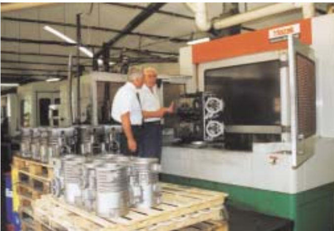
Die Gehäusebearbeitung der semihmermetischen Verdichter erfolgt bei Dorin in Scandicci (zwei Fertigungsstätten) mit 25 Mitarbeitern, kein Bearbeitungszentrum ist älter als 5 Jahre. Mario Dorin einmal im Gespräch mit Production Manager Alberto Dami, dann bei den Gußgehäusen vor der Weiterverarbeitung. Etwa 70 000 semihmermetische Motorverdichter verließen im Jahr 2000 das Werk Compiobbi
