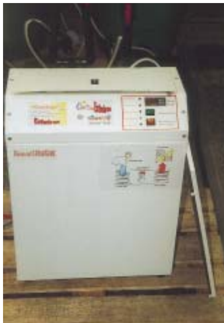
Heizen mit Erdwärme. In Österreich gibt es etwa 10 Firmen, die erdgekoppelte Heizungs-wärmepumpen mit Kältemitteldirektexpansion serienmäßig herstellen. Die Heliotherm-Wärmepumpe befindet sich gerade für 14 Tage auf dem Prüfstand
