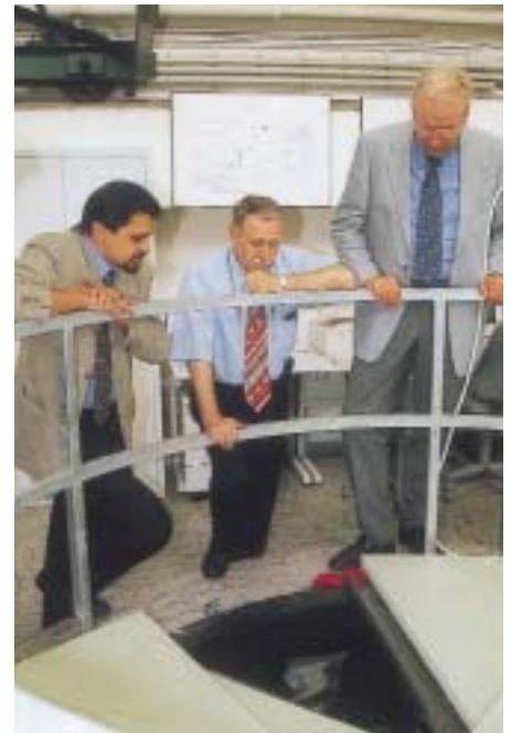
Der komplette Prüfstand. Im unteren Teil befindet sich der Erdreichsimulator der mit einem Glykol/Wassergemisch gefüllt ist
