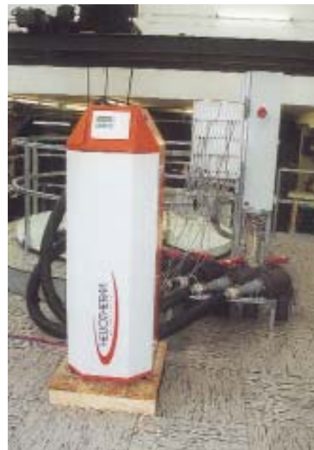
Heizen mit Erdwärme. In Österreich gibt es etwa 10 Firmen, die erdgekoppelte Heizungs-wärmepumpen mit Kältemitteldirektexpansion serienmäßig herstellen. Die Heliotherm-Wärmepumpe befindet sich gerade für 14 Tage auf dem Prüfstand
