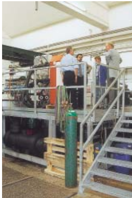
Der komplette Prüfstand. Im unteren Teil befindet sich der Erdreichsimulator der mit einem Glykol/Wassergemisch gefüllt ist
