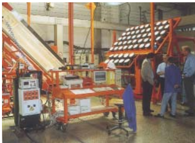
Solarthermie und Photovoltaik sind wichtige Bausteine für die effiziente Gewinnung von Wärme und Strom aus erneuerbaren Energieträgern. Auf dem Gelände von arsenal research erfolgt auch eine praxisnahe Prüfung von Sonnenkollektoren und Photovoltaik-Komponenten
