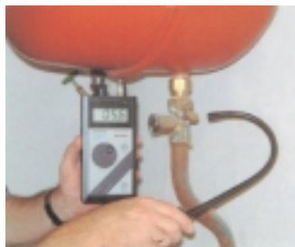
Das Sonaphone bei der Druckluft-Lecksuche
