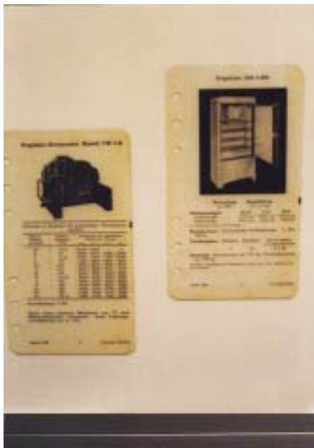
„Das Beste wär' ein Frigidaire!“ Auszug aus dem Frigidaire Produkt- und Leistungsdatenbuch (damals einmalig) von 1938: Wassergekühlter Kompressor CW 7 K, mit 4 PS Elektromotor um die 6000 kcal/h Kälteleistung, und Haushaltskühlschrank DH I-200, 200 Liter Inhalt, Reingewicht ca. 174 kg (!)
