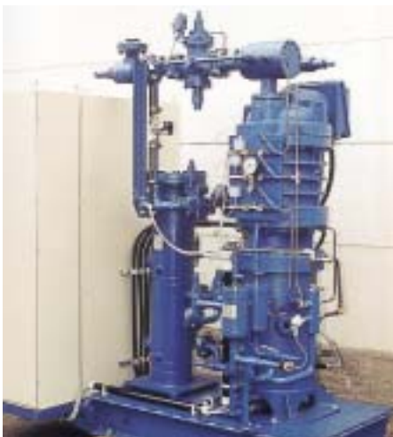
Variscrew-Verdichter VMY 037 der Aerzener Maschinenfabrik mit Ölmanagement
