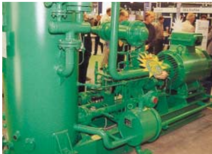
Das Grasso-CO 2 -Kaskadenaggregat für die umweltschonende Tiefkühlösung
