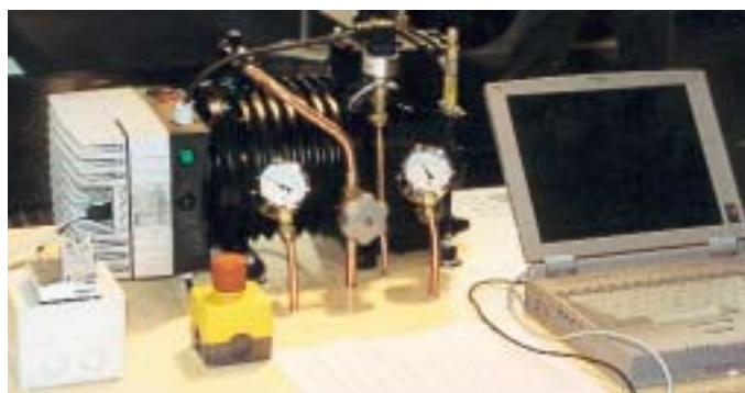
Die Anpassung der frequenzgeregelten Goeldner-Verdichter von HKT an den Leistungsbedarf wurde anschaulich vorgeführt
