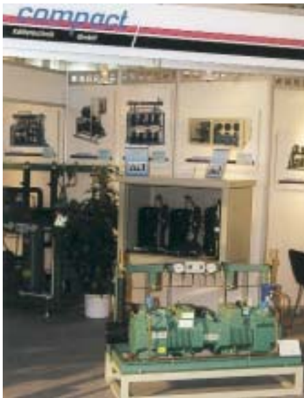
Mit 2 × 4 Zylindern in Twin-Ausführung wird ein compact-Spezialkältesatz realisiert
