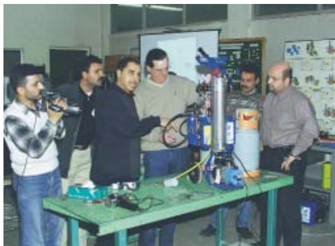
Hier wird durch einen syrischen Trainer in Damaskus die Funktion der R & R-Station Multi R mit integrierter Vakuumpumpe erläutert
