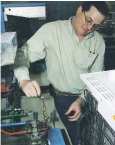
Rolf Hühren bei der Vorführung einer Ventilkerntfernung mit einem Cove removal tool in Damaskus
