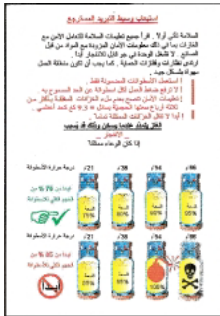
„Learning by doing“. Hierzu gehörte eine exakte Vorbereitung von Schulungsunterlagen durch die Firma Hühren. Wie man die Kältemittelbe- und -rückbefüllung temperaturabhängig handhaben muß, zeigt recht eindrucksvoll Seite 13 der R & R-Schulungsunterlagen in englischer bzw. syrischer Sprache
