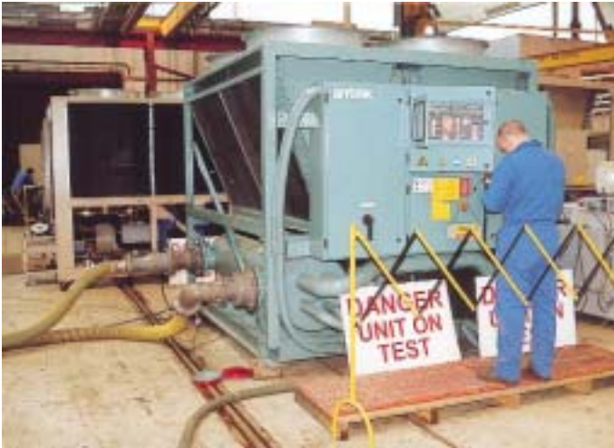
Generell erfolgen erste thermische und energetische Leistungstests nach Fertigstellung der Maschinen noch innerhalb der Produktionshalle. Hier an zwei unterschiedlichen Ausführungen luftgekühlter Kältemaschinen
