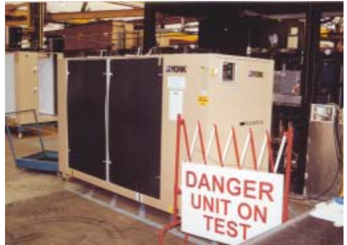
Generell erfolgen erste thermische und energetische Leistungstests nach Fertigstellung der Maschinen noch innerhalb der Produktionshalle. Hier an zwei unterschiedlichen Ausführungen luftgekühlter Kältemaschinen
