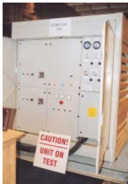
Thermische und akustische Leistungstests können an luft- und wassergekühlten Kältemaschinen sowie Wärmepumpen bis zu einer Gerätelänge von 7,50 m im schalltoten Raum des neuen Testlabors vorgenommen werden
