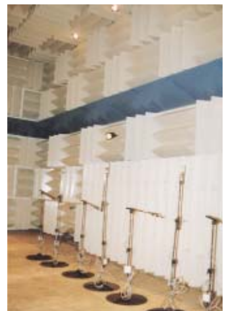
Thermische und akustische Leistungstests können an luft- und wassergekühlten Kältemaschinen sowie Wärmepumpen bis zu einer Gerätelänge von 7,50 m im schalltoten Raum des neuen Testlabors vorgenommen werden
