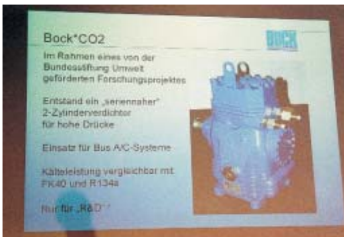
Einige Aussagen und Merkmale über den Bock-2-Zylinder-Hubkolbenverdichter für CO 2 -Anwendungen im transkritischen Prozeß enthalten die hier veröffentlichten Folien
