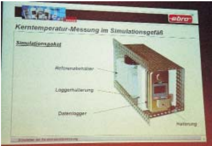
Kerntemperatur-Messung über ein Simulationsgefäß und seine Anordnung einschließlich Datenlogger in einem Iso-Tainer
