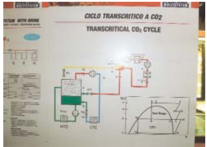
Gegenwart und Zukunft. Links eine Systemdarstellung des \text{NH}_3/\text{R} 404\text{A}-\text{CO}_2 -Kaskadensystems, rechts der transkritische \text{CO}_2 -Prozeß mit Pumpenbetrieb
