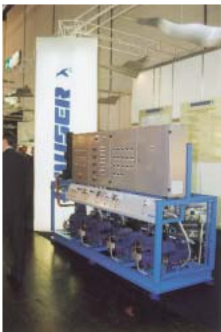
Verbundanlagen mit semihermischen Bock-Verdichtern
