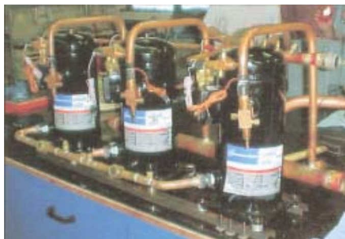
Bild 3 Versuchsanlage mit 3 ZF18/ZS45
