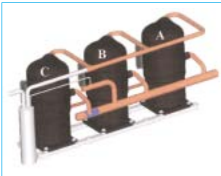
Bild 4 Ölrückführung über die Saugleitung
