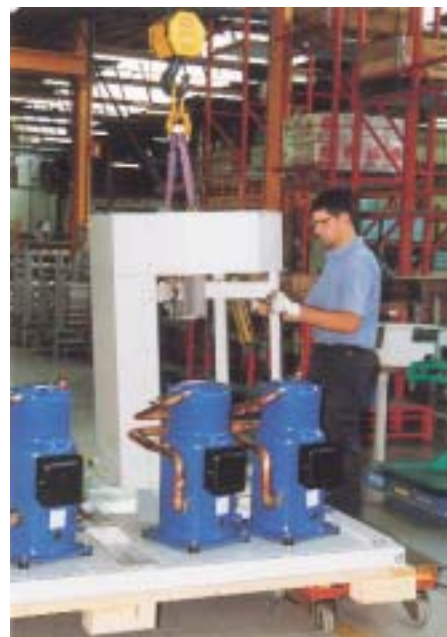
Hydronik-Lösungen am Band. Ein Blick in die Fertigungsabläufe des Flüssigkeitskühlers Aquasnap. Zulieferung nach dem Kanban-System „Just-In-Time“
