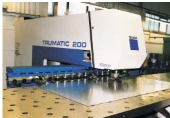
Stanzen, Schneiden. Moderne automatische Blechbearbeitung
