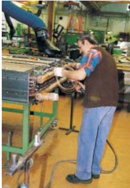
Rohrbiegen, Hartlöten, Leckdichtheitstest – Eindrücke aus der Wärmetauscher-Fertigung für die Kälte- und Klimatechnik
