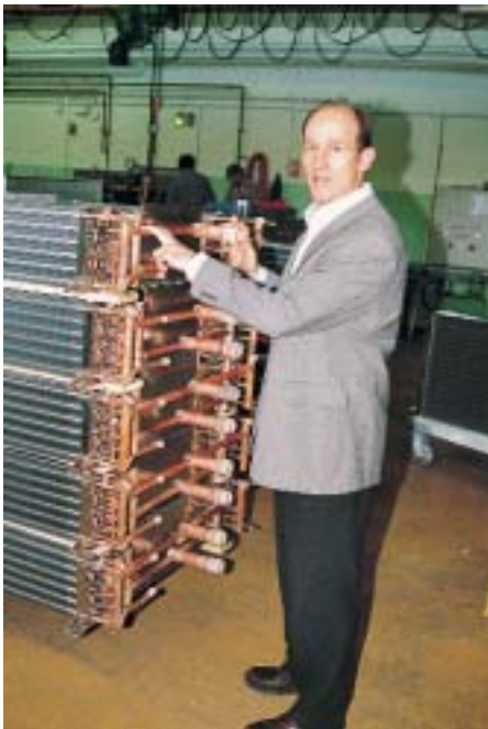
Hanns Christoph Rauser erklärt Rollers Lamellenwärmeaustauscher der Marke AIRSOL® im Fertigungszustand
