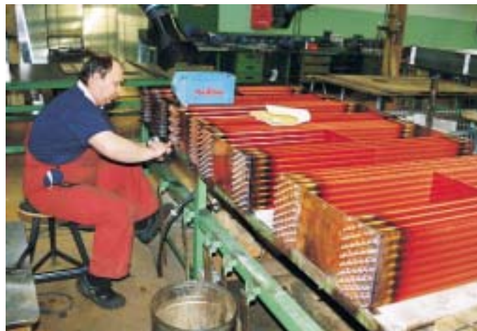
Sonderbau in Serie für OEMs. Kupfer/Kupfer-Wärmetauscher-Batterien, hier gezeigt von Geschäftsführer Werner Rose, oder Lamellenwärmeübertrager mit Goldlackbeschichtung
