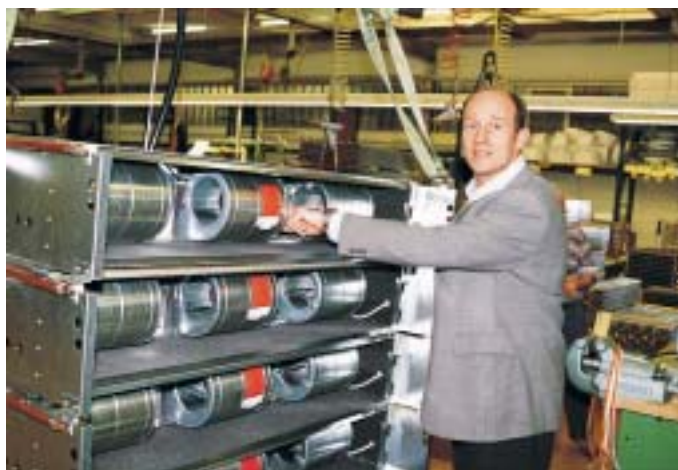
Hierauf ist man bei Roller besonders stolz: Automatische Aushalsung von Kupferrohr-Anschlüssen bis 133 mm Durchmesser
