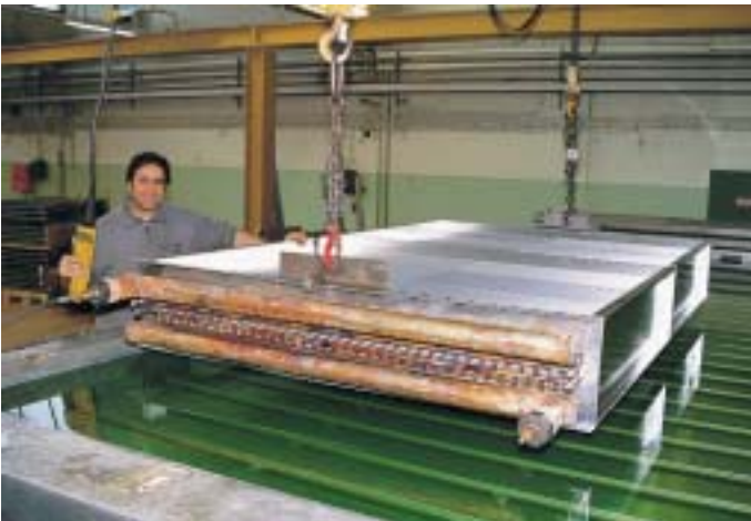
Rohrbiegen, Hartlöten, Leckdichtheitstest – Eindrücke aus der Wärmetauscher-Fertigung für die Kälte- und Klimatechnik
