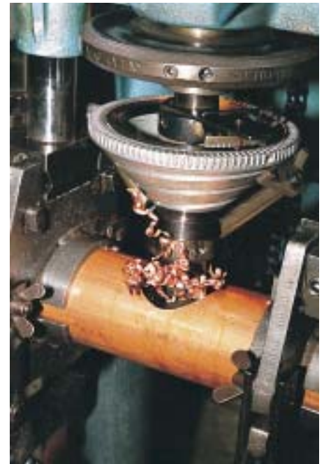
Hierauf ist man bei Roller besonders stolz: Automatische Aushalsung von Kupferrohr-Anschlüssen bis 133 mm Durchmesser
