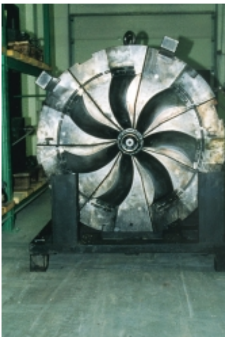
Das Prunkstück: Mit diesem Werkzeug werden Sichelventilatoren von 1 m Durchmesser gegossen
