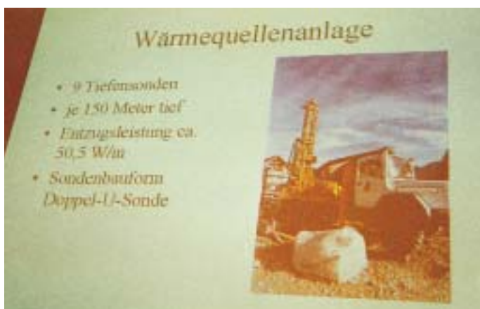
3 Mehrfamilienwohnhäuser mit je 7 Wohnungen werden durch je eine Sole/Wasser-Wärmepumpe mit 35 kW Heizleistung und der Erdwärmequellen-nutzung durch 9 Tiefensonden (jeweils 150 Meter tief) versorgt
