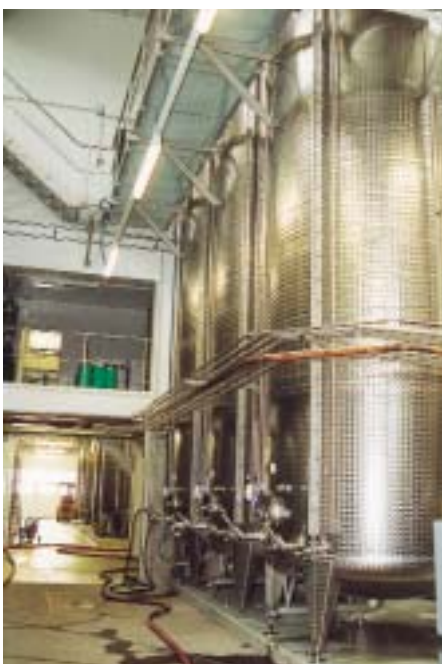
Das sind keine Orgelpfeifen sondern Tanks. Links Kallstadt, rechts Alzey, in der Mitte eine Detailansicht zur Rohrleitungsführung Kältemittel/Wasser. Fruchtige und aromareiche Weine benötigen eine Vergärung bei 18 °C und tiefer. Bei der Kältemitteldirektverdampfung wird das Kältemittel direkt in den Doppelmantel eingespritzt bzw. in die Edelstahl-Wärmetauscherplatten
