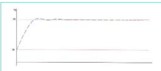
Die Gärtemperaturregelung erfolgt mittels des von Löffler entwickelten DRS-Reglers. Das System besteht aus Fühler, Magnetventil, Regler, PC-Schnittstelle und Überwachungssoftware. Bis zu 10 Regler können als Modul in einem Zentralsteuerschrank zusammengefaßt werden
