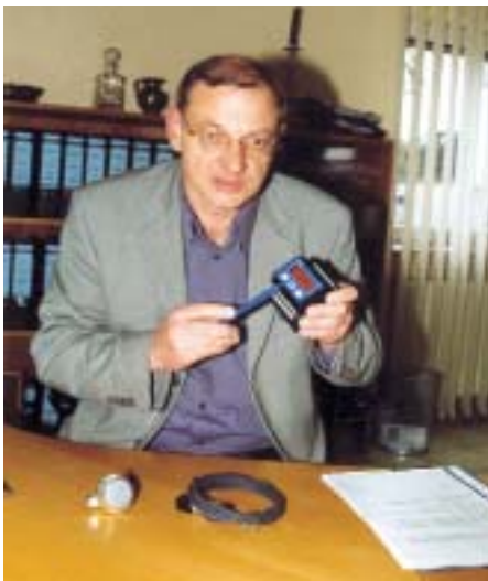
Die Gärtemperaturregelung erfolgt mittels des von Löffler entwickelten DRS-Reglers. Das System besteht aus Fühler, Magnetventil, Regler, PC-Schnittstelle und Überwachungssoftware. Bis zu 10 Regler können als Modul in einem Zentralsteuerschrank zusammengefaßt werden
