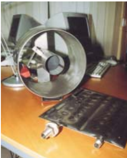
Schnitt durch einen Kratzkühler, davor eine Edelstahl-Wärmetauscherplatte für die Tankkühlung. In Betrieb ein Doppelstockkratzkühler zur Weinsteinstabilisierung in der Weinkellerei Trautwein
