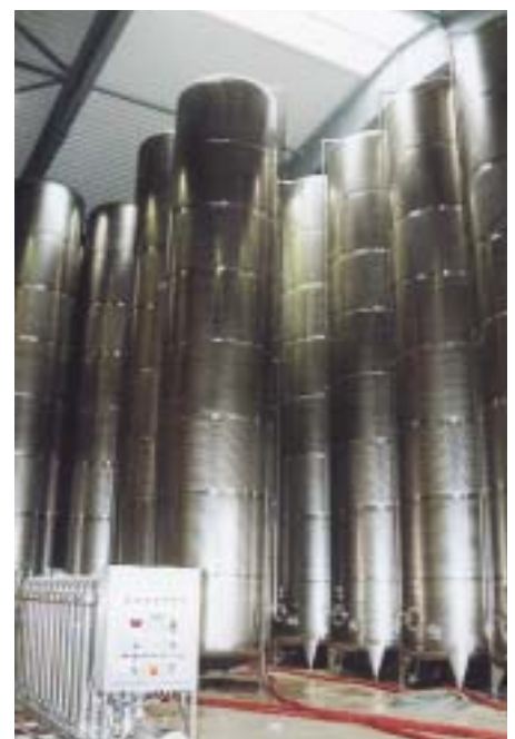
Das sind keine Orgelpfeifen sondern Tanks. Links Kallstadt, rechts Alzey, in der Mitte eine Detailansicht zur Rohrleitungsführung Kältemittel/Wasser. Fruchtige und aromareiche Weine benötigen eine Vergärung bei 18 °C und tiefer. Bei der Kältemitteldirektverdampfung wird das Kältemittel direkt in den Doppelmantel eingespritzt bzw. in die Edelstahl-Wärmetauscherplatten
