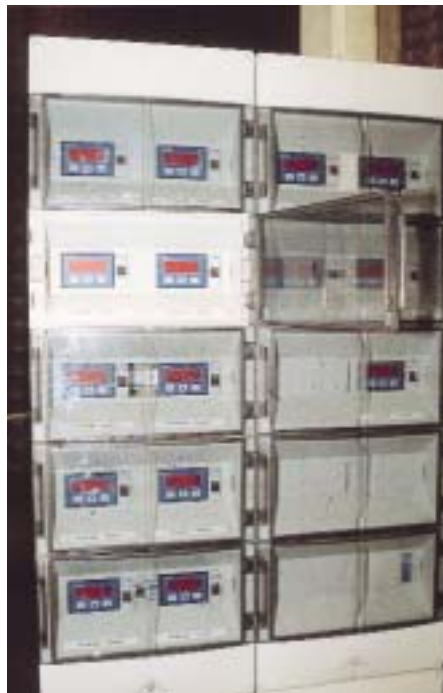
Mit dem DRS Regler KS1G sind frei einstellbare Temperaturkurven möglich. Die maximale Temperaturzunahme läßt sich in Werte ab 0,1 K einstellen
