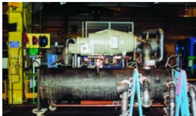
... sind es in Charmes die großen Chiller bis 1,5 MW. Hier ist vorwiegend Handarbeit angesagt
