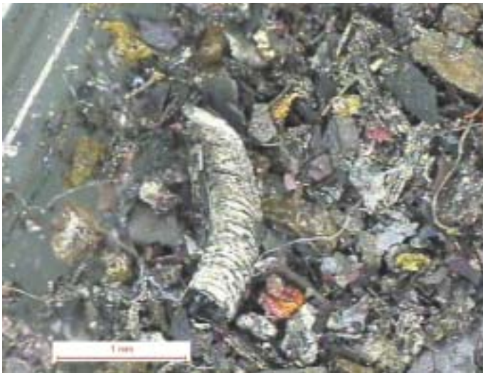
Bild 1.2 Verunreinigungen im Ölsumpf
