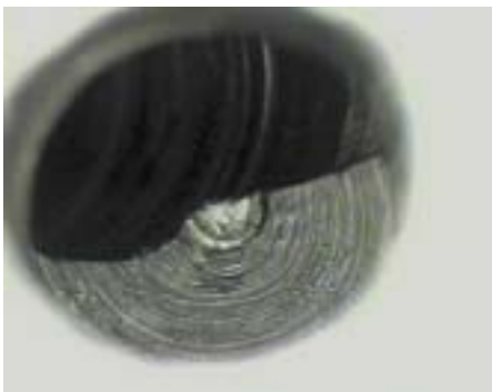
Bild 3.1 Fast verschlossener Ölkanal
