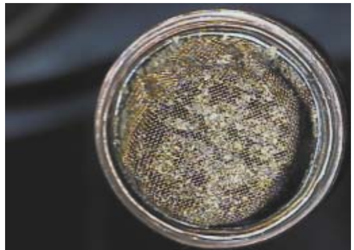
Bild 2 Abrieb des Trocknermaterials im Filter einer Trocknerpatrone
