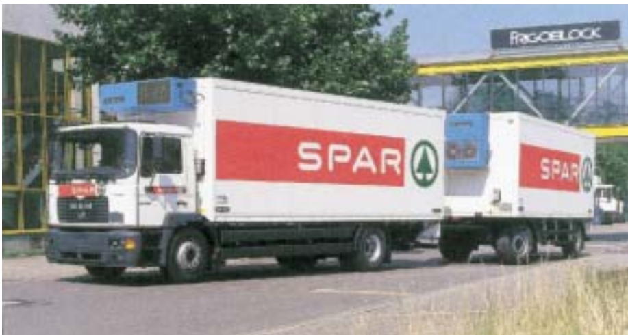
FRIGOBLOCK FK 13 L (Motorwagen) und HK 13 L (Hänger), mit Generatorantrieb (G24), MAN 18.285 MLLC
