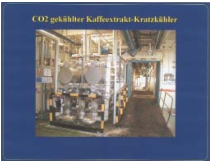
Bild 12 Detailansicht von in Betrieb befindlichen CO 2 -Pumpen
