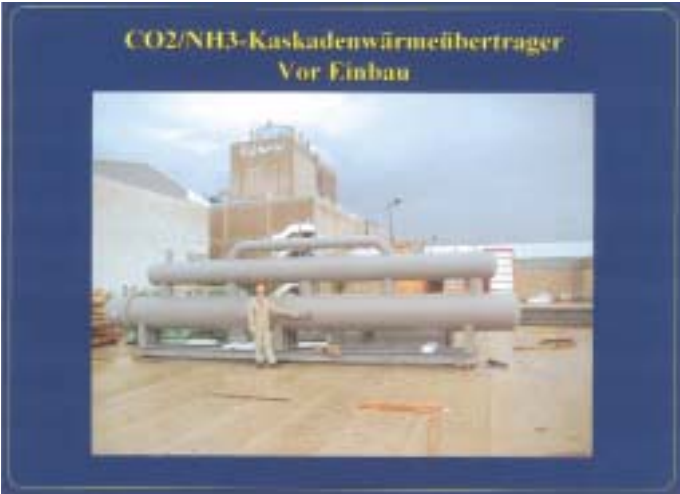
Bild 9 Unisolierter Kaskadenwärmeübertrager vor dem Einbau ...
