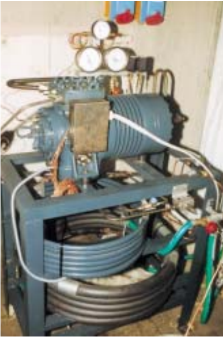
Bild 5 2stufiger CO 2 -Verdichter auf dem Prüfstand. Die erste Stufe arbeitet bei 67 bar, die zweite Stufe bei 112 bar
