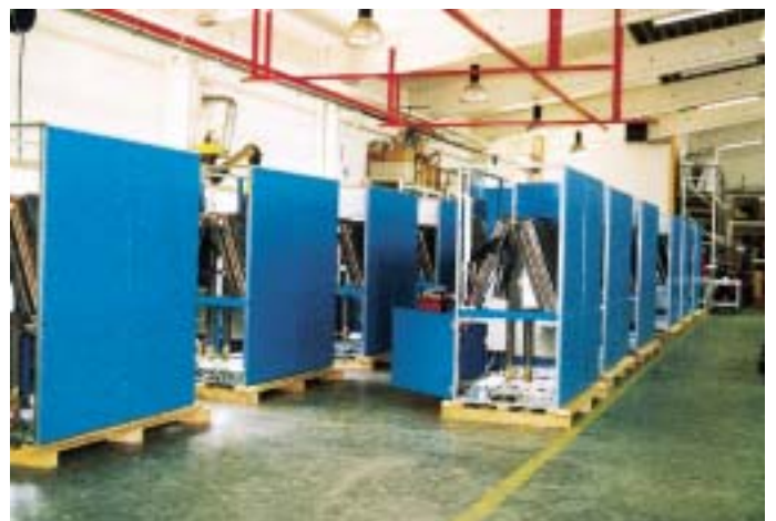
Ein Eindruck über den Fertigungsverlauf von AT4-C-Klimaschränken, hier bestimmt für das neue Rechenzentrum von SAP in Walldorf
