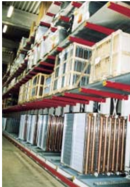
Eine Teilansicht des Fertigteilelagers für die Geräteherstellung, hier zu sehen einige lamellierte Wärmetauscher aus Alu/Kupfer für die AT4-Baureihe sowie doppelseitig ansaugende Ventilatoren
