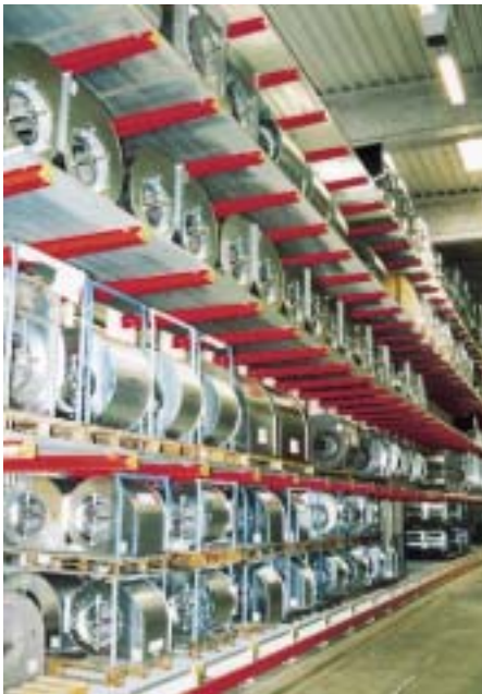
Eine Teilansicht des Fertigteilelagers für die Geräteherstellung, hier zu sehen einige lamellierte Wärmetauscher aus Alu/Kupfer für die AT4-Baureihe sowie doppelseitig ansaugende Ventilatoren
