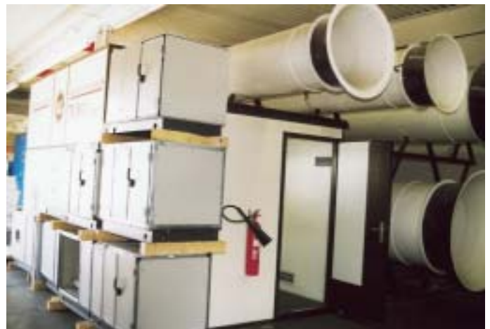
AL-KO-Kammerprüfstand für RLT-Geräte in Anlehnung an DIN 24 163, sowohl der kleine als auch der große Klimaschrank zählen zur Baureihe AT4-C, die erstmals auf der IKK gezeigt werden
