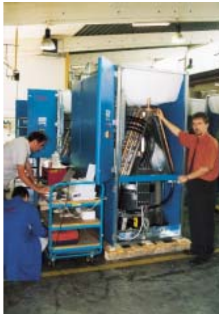
Die Luftführung bei den AT4-C-Klimaschränken erfolgt über V-förmig angeordnete Wärmeaustauscher durch einseitig saugende und frei ausblasende Radialventilatoren, hier, von Dipl.-Ing. Bernd Kober der KK erklärt, eine Ausführung mit unterem Luftauslaß in den Doppelboden. Auf dem linken Bild erläutert Regelungstechniker Jochen Petz Funktionen der vollautomatischen Endkontrolle: Über Laptop wird eine Software eingespielt, die es dem Klimaschrank ermöglicht, seine Funktionen selbst zu testen
