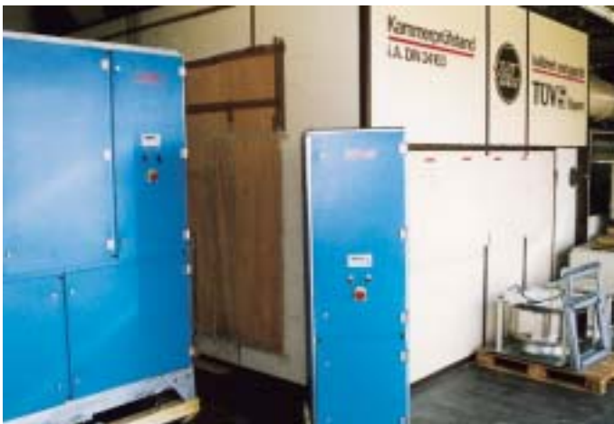
AL-KO-Kammerprüfstand für RLT-Geräte in Anlehnung an DIN 24 163, sowohl der kleine als auch der große Klimaschrank zählen zur Baureihe AT4-C, die erstmals auf der IKK gezeigt werden
