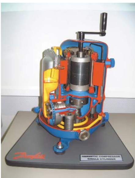
Und hier – für alle, die es etwas genauer sehen wollen: Das Verdichterschnittmodell in Großaufnahme
