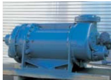
Der Größte: Aerzener Schraubenverdichter der Baugröße VMY 536
