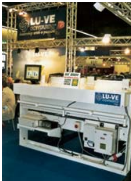
Bei den LU-VE Contardo Luftkühlern gab es die neuen BENEFIT-Hochleistungsgeräte zu sehen. Diese reduzieren die Kosten für den Energieverbrauch durch die Verwendung eines elektronischen Motors wesentlich. Der Betrieb der Anlage wird mit dem neuen JET-O-MATIC-Verteiler weiter optimiert, wodurch bei allen Betriebszuständen eine gleichmäßige Füllung des Verdampfers erreicht wird
