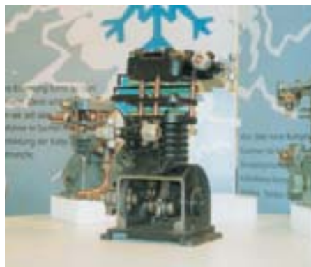
Zur Betrachtung der technischen Einzelheiten aufbereitete historische Hubkolbenverdichter
