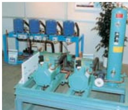
Verdichtersätze mit Bitzer-Octagon- und Man-eurothermetikverdichter am Stand von compact
