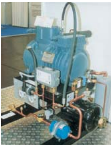
Kundenspezifischer kleiner Verdichtersatz mit Drehzahlregelung von Erba Kälte mit Dorin-Verdichter
