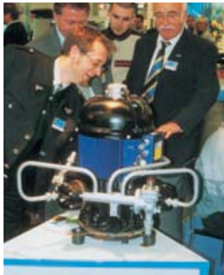
Der Frigopol-Trennhaubenverdichter für NH 3 mit der äußeren Druckleitungsführung fand große Aufmerksamkeit
