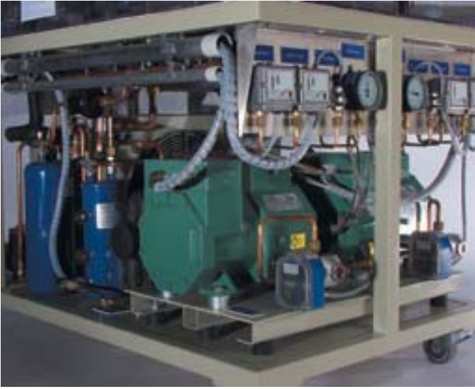
Bild 5 Das Ölreguliersystem der Firma Schultze
