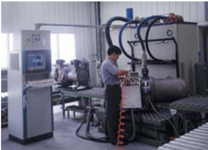
Endmontage Schraubenverdichter mit Qualitätsprüfung
