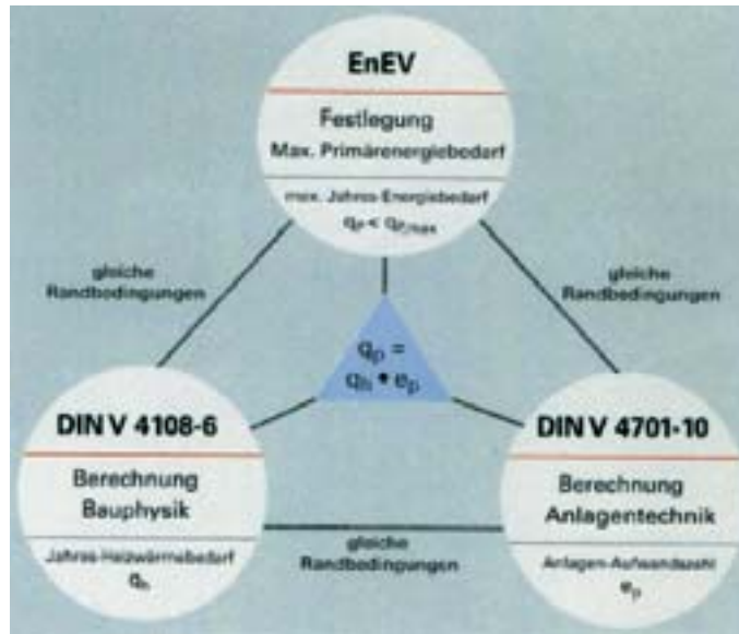
Hier ist das Zusammenwirken der Normen bei der Berechnung schematisch dargestellt (nach Holtfort)
