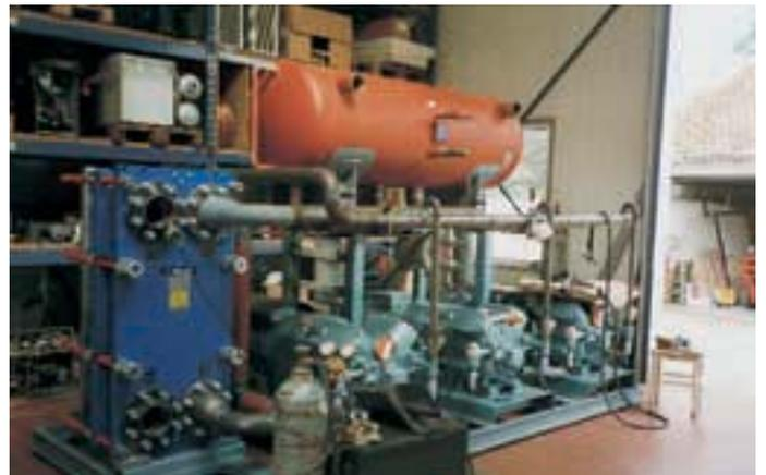
1999, Anfertigung von  $\text{NH}_3$ -Flüssigkeitskühlern mit Kolbenverdichtern für die Druckerei Schröder & Wagner, Rinteln, in der Werkstatt von Anderten in Messenkamp
