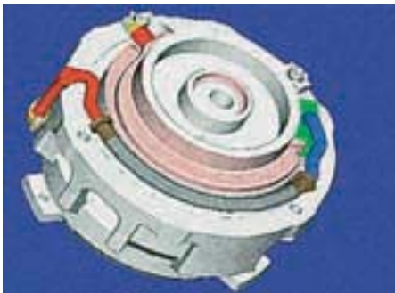
Bild 14 Scroll Modifikation für Dampfeinspritzung
