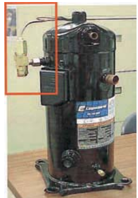
Bild 9 Verdichter mit DTC-Ventil
