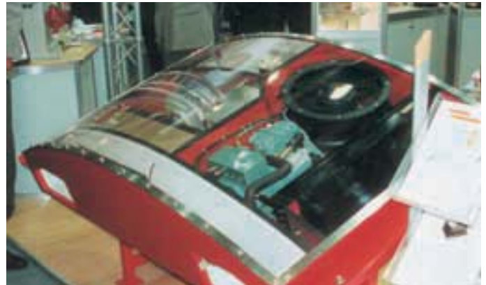
Dachgerät für die Fahrerstandsklimatisierung von BEHR Industrietechnik
