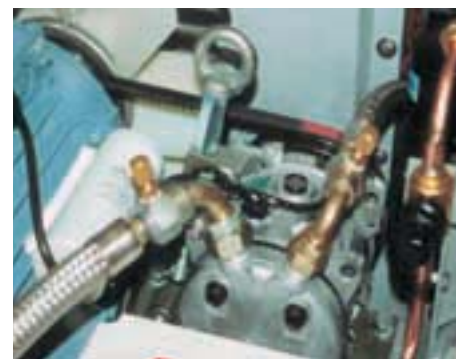
Motor-Verdichter-Block im Lumikko®-Führerstandsklimagerät
