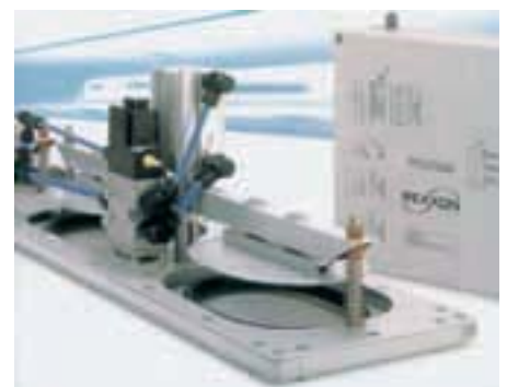
Druckschutzventil mit Stelleinheit von ITEG und Druckschutzsteuerung von Rexxon
