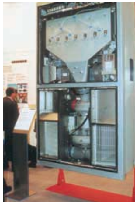
Kaltluftklimagerät von LIEBHERR in senkrechter Stellung auf dem beengten Messestand, unten in der Mitte der Turbomaschinensatz, oben die Kaltluftzufuhr zum Zuluftkühler
