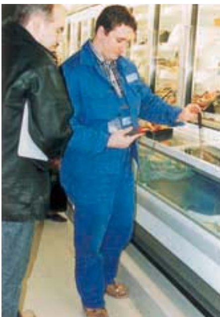
Servicemeister Andreas Borst (Dresdner Kühlanlagenbau) überprüft die Temperaturverteilung an der Oberfläche einer Truhenabdeckung
