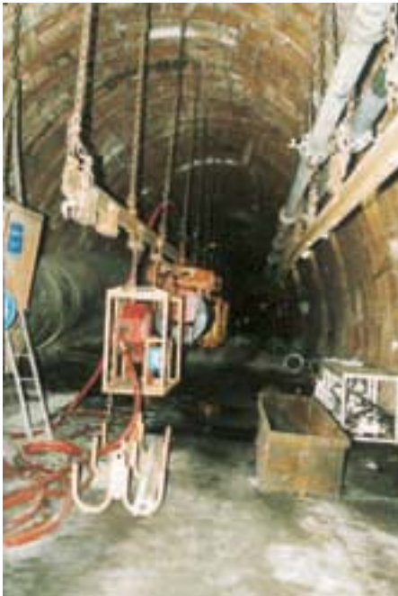
Ein kleiner Eindruck von den Schachtanlagen und ihren technischen Vorkehrungen für Rohrleitungs- und Kabelführungen vor Ort. Trotz aller Mechanisierung steht aber der Mensch unverändert im Mittelpunkt. Im Hintergrund rechts ein Förderkorb (12 m/s)
