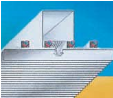
Bild 3 Die Untersicht eines 30 cm breiten Kühlpaneels „Inducool“ mit Zuluftanschluß. Leistung: Bis zu 500 W/m (Bild: Kiefer)
