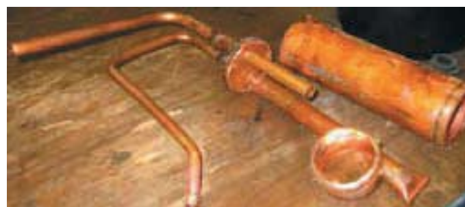
Bild 3 Flüssigkeitsabscheider nach dem Spülen mit HFE-72DE
