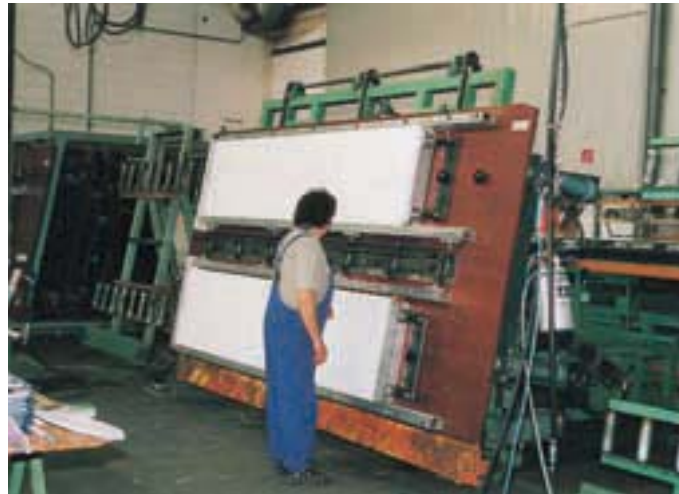
Vorbereitung von Kühlzelelementen zur Verschäumung. Als Treibmittel wird schon seit 1994 der chlor- und fluorfreie Kohlenwasserstoff Cyclopentan verwendet
