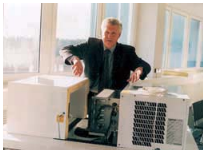
Sehr bediener- und wartungsfreundlich sind die bei Viessmann hergestellten Kühl- und Tiefkühlaggregate mit im Zellendach eingebauten Verdampferventilator. Kundenbetreuer Karl Bühl zeigt das hier
