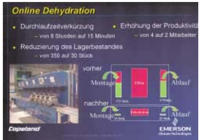
Investitionen zahlen sich aus, hier veranschaulicht an der neuen Dehydrationsstufe zur Trocknung der Verdichterwicklungen
