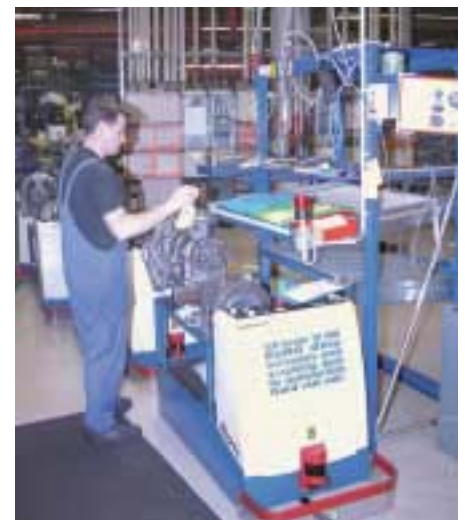
Auf solchen Wagen fahren die Verdichter neuerdings alleine entlang der Produktionslinie, ...
