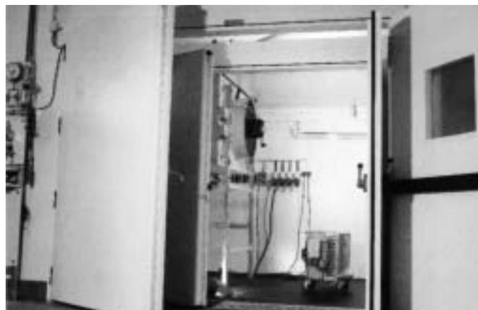
Bild 3 Blick in den mittleren Prüfraum durch die geöffneten Türen. Es ist die Doppelwandigkeit der Prüfkammern zu erkennen
