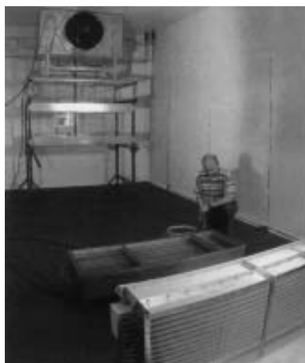
Bild 5 Betriebsprüfung eines Luftkühlers durch Simulation des Kühlbetriebes und der Abtauung unter realen Bedingungen
