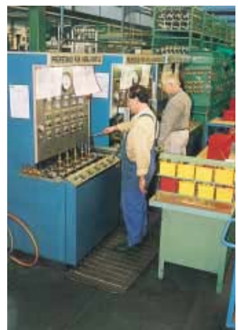
Prüfstand für kleine Ventilgrößen (r.), die zu je 5 Stück mittels Schauglas und zusätzlich auch über eine optische Anzeige auf Dichtheit geprüft werden
