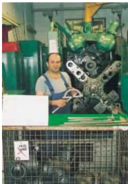
Aus der Fertigung. Bearbeitung von großen Ventilgehäusen. Links die Sitzbearbeitung eines Eckventils DN 250. Ventilgehäuse bis DN 200 werden auf Drehautomaten bearbeitet. Rechts Einspannen eines Gehäuses und Kontrolle auf Maßhaltigkeit
