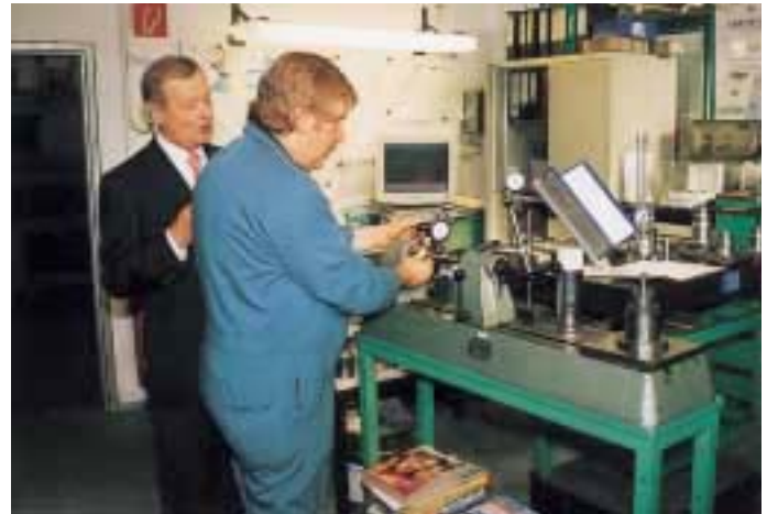
CNC-Bearbeitung von Oberteilen bis DN 400 (l.). Qualitätskontrolle von Fertigteilen beim Wareneingang (r.) im Rahmen von ISO 9001. Im Bild die Kontrolle von Ventil-Spindeln, a) des Gewindes, b) der Spindel-Gleitfläche
