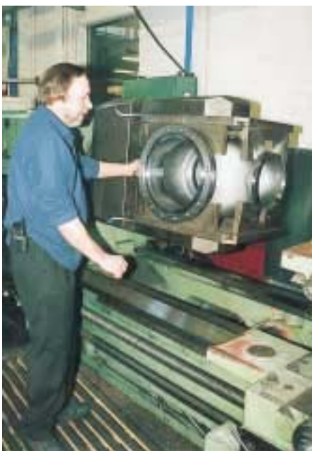
Aus der Fertigung. Bearbeitung von großen Ventilgehäusen. Links die Sitzbearbeitung eines Eckventils DN 250. Ventilgehäuse bis DN 200 werden auf Drehautomaten bearbeitet. Rechts Einspannen eines Gehäuses und Kontrolle auf Maßhaltigkeit
