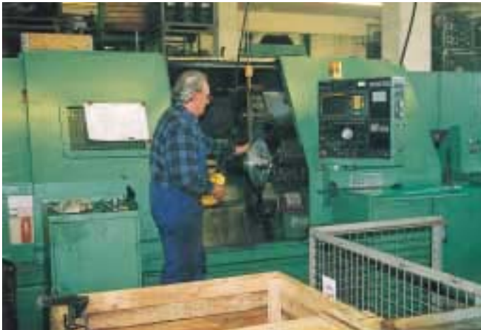
CNC-Bearbeitung von Oberteilen bis DN 400 (l.). Qualitätskontrolle von Fertigteilen beim Wareneingang (r.) im Rahmen von ISO 9001. Im Bild die Kontrolle von Ventil-Spindeln, a) des Gewindes, b) der Spindel-Gleitfläche
