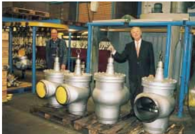
Ein Eindruck aus dem Versand (l.). Nach der Prüfung und der Lackierung werden die Ventile verpackt und zur Abholung durch den Spediteur bereit gestellt. 2 Eckventile DN 350 und 2 Eckventile DN 400 sind versandfertig (r.). Sie sind bestimmt für eine NH 3 -Anlage eines Food-Herstellers in den USA
