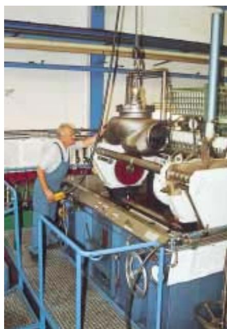
Prüfstand (l.) ist für große Ventile (DN 200 bis 400) geeignet.
