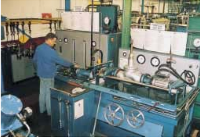
Prüfanlage für mittlere Ventilgrößen (links, unter Wasser). Jedes einzelne Ventil wird auf Festigkeit und Dichtheit geprüft. Auf dem Bild rechts erklärt Firmenchef Fred Herl die Einstellung von Sicherheitsventilen auf dem Prüfstand
