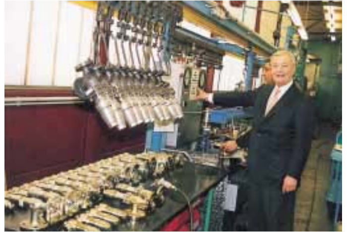
Prüfanlage für mittlere Ventilgrößen (links, unter Wasser). Jedes einzelne Ventil wird auf Festigkeit und Dichtheit geprüft. Auf dem Bild rechts erklärt Firmenchef Fred Herl die Einstellung von Sicherheitsventilen auf dem Prüfstand
