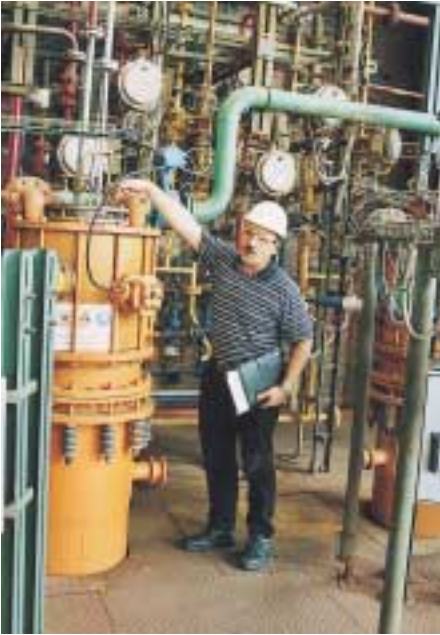
Das Herzstück des Sekundär-Recycling-Verfahrens von Solvay Fluor in Frankfurt-Höchst besteht aus der Hochtemperatur-Spaltkammer, in deren oberen Teil zur „Befuerung“ ein Wasserstoff/Sauerstoffgemisch (linkes und rechtes Bild) zur Erzeugung einer Knallgasflamme hinzugeführt wird. Nähere Erläuterungen hierzu gibt Dipl.-Ing. Martin Selt, Leitung Produktion
