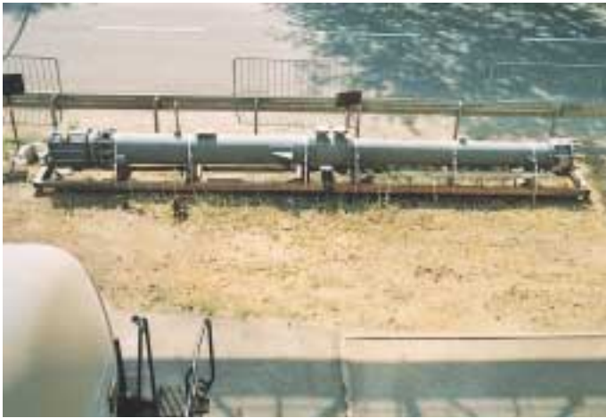
Horizontal gelagert, vertikal betrieben: ein ca. 6 Meter langer Ersatzreaktor zur Erzeugung der Recycling-Produkte Fluß- und Salzsäure in Verkaufsqualität
